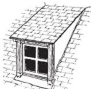
lucarne rampante ou en chien couché
