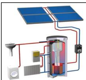
Principe de fonctionnement d'un panneau solaire thermique
